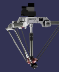
5D Delta Picker 3D mit Dreh- und Schwenkachse
