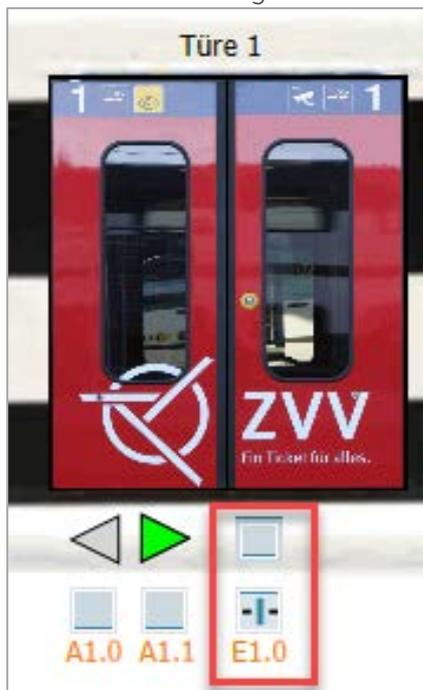
Mit diesen Button können die Endschalter von Hand simuliert werden um die Fehler zu testen!
