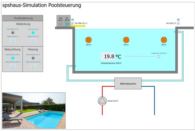
In der Simulation werden alle Ein- und Ausgangssignale für die drei Aufgaben simuliert.
