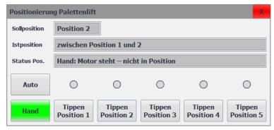
Bei Bedarf kann der Bildbaustein "BB\_MOT\_MAX\_5POS" für das HMI verwendet werden. Abhängig vom Parameter "ea\_Para.Anz\_Positionen" werden die Tasten "Tippen Position 1..5" angezeigt. Sie können den Bildbaustein auch individuell auf Ihre Bedürfnisse anpassen.
